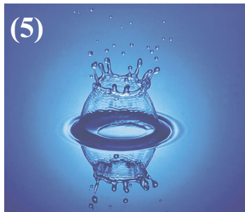
圖四 (1) 泡泡由頂部液體較薄處開始破裂，形成一個圓形的膜洞；(2) 液體會在膜洞周圍累積成一個甜甜圈形的液環；(3) 逐漸擴大的液環表面不穩定；(4) 液環斷裂成較小的液滴，並沿切線方向飛出，所拉出的液柱也會因不穩定而碎裂成小液滴；(5) 利用高速攝影技術攝得液膜破裂的情形 (取自 http://www.rit.edu/~andpp/exhibit-3.html , 經 A. Davidhazy 授權使用)。
